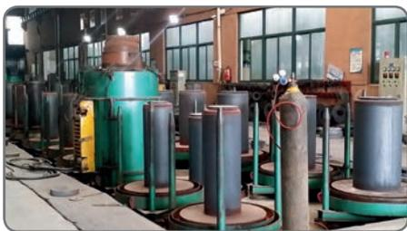
Sintern unter Druck und Hitze
